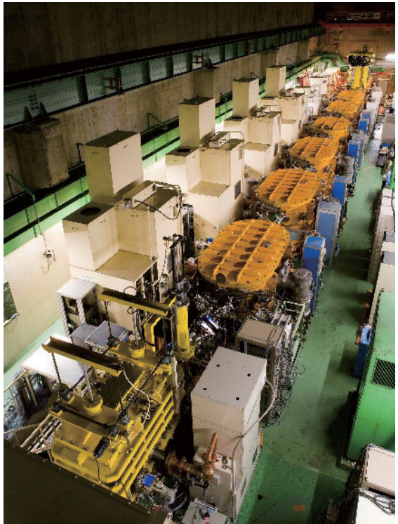
写真 日本発の新元素ニホニウムを合成した重イオン線形加速器 全長約40mに及ぶ機器で、写真右上から左下に向かってイオンが光速の10%程度まで加速する。がん治療への応用が期待されるアスタチン211を実用レベルで製造可能（提供＝理研）。
