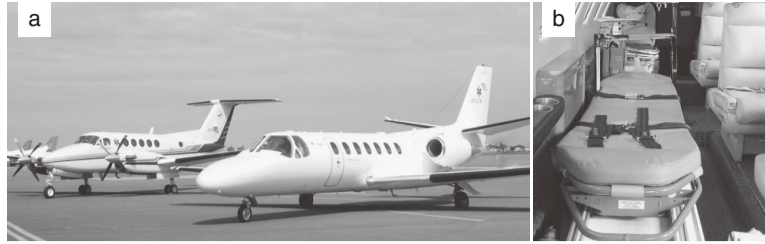
●写真 メディカルウイングで使用される機体と機内の様子(奈良氏提供) a: 使用機体は、左からBeechcraft King Air 200, Cessna 560。b: 機内には、医療機器用の電源、酸素供給や吸引装置などが備え付けられている。
