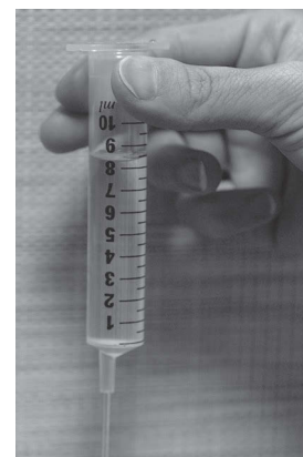
●写真2 シリンジ法の様子 10 mLのシリンジに液体を入れ、10秒間自然落下させた後の残留量を計測する。
