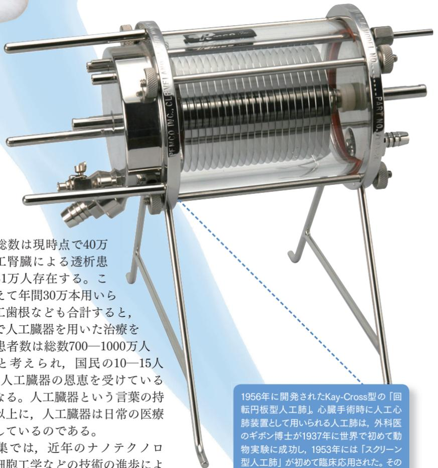
1956年に開発されたKay-Cross型の「回転円板型人工肺」。心臓手術時に人工心肺装置として用いられる人工肺は、外科医のギボン博士が1937年に世界で初めて動物実験に成功し、1953年には「スクリーン型人工肺」が初めて臨床応用された。その後「回転円板型人工肺」へと進化し、1960年代に普及した。現在は1979年にわが国の研究グループによって開発された「多孔質中空糸膜」を用いた「膜型人工肺」が広く使用されている。
